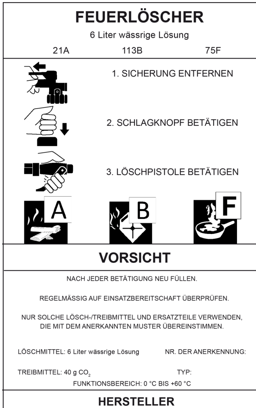
Abb. 1: Beispiel für die Beschriftung eines Feuerlöschers durch den Hersteller, in Anlehnung an DIN EN 3-7:2007-10 „Tragbare Feuerlöscher - Teil 7: Eigenschaften, Leistungsanforderungen und Prüfungen“
